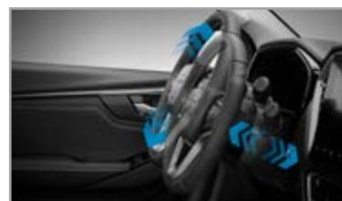
Výškově a podélně nastaviteľný volant
